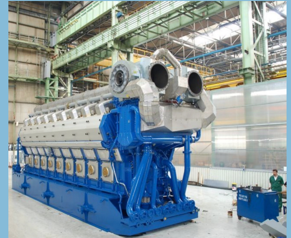
Wärtsilä 18V50SG. Output: 18.8 MW
